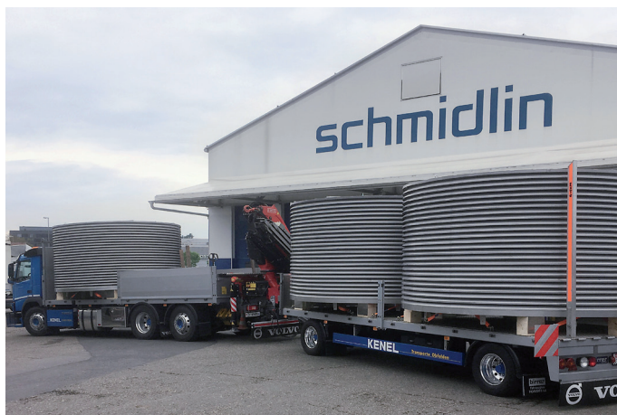
Transport der Lamell-Säulenhüte mit einem Durchmesser von 3,5 Metern.
